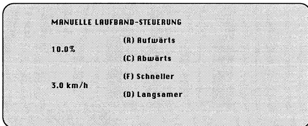
Ganz links sind die momentane Steigung und Geschwindigkeit angezeigt. Mit der Taste **R** kann die Steigung in Schritten von 0.5% bis auf maximal 25% erhöht werden, mit der **C**-Taste wird sie in Schritten von 0.5% reduziert.
