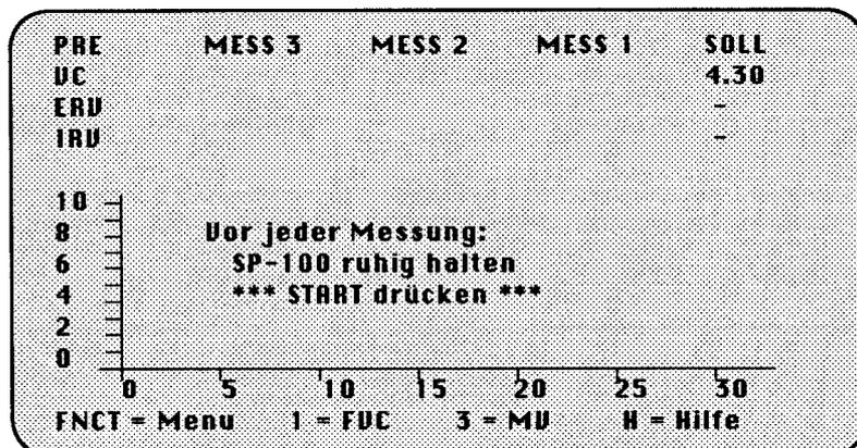
Auf dem Bildschirm werden die zu ermittelnden Messwerte und die Sollwerte angezeigt. Für die Anzeige der Resultate stehen drei Spalten zur Verfügung, so dass mehrere Tests durchgeführt werden können. Auf der vertikalen Achse der Graphik wird das Atemvolumen in Litern angegeben und auf der horizontalen Achse die Zeit in Sekunden.
